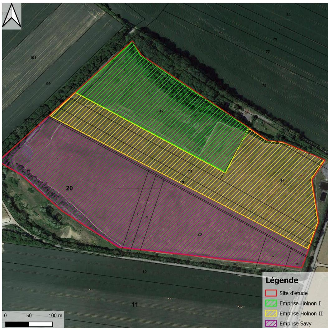
Le projet d'aménagement prévoit la mise en place de 28 000 panneaux photovoltaïques posés sur le sol par l'intermédiaire de longrines en béton. Le plan des futurs aménagements est présenté en Annexe 2.
